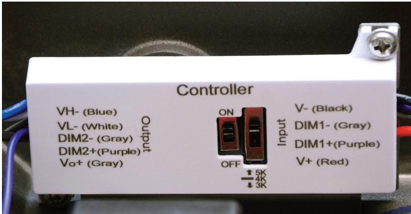
Utilisez l'interrupteur allumé / éteint pour contrôler la commande photosensible. Utilisez l'interrupteur TCP pour régler la température de la couleur. (3000K ou 4000K ou 5000K).
