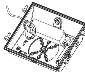
10. Installez le couvercle supérieur du luminaire et connectez le bloc des terminaux.
