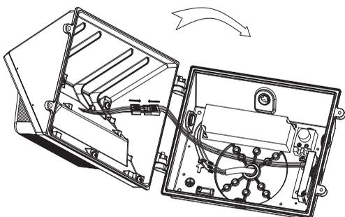
11. Attachez le luminaire avec des vis.
