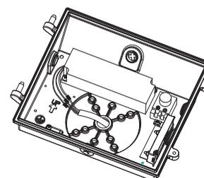
10. Installez le couvercle du luminaire et connectez le bloc des terminaux.
