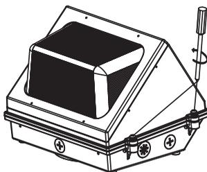
3. Ouvrez le luminaire, déconnectez les terminaux de connexion et enlever le couvercle supérieur du luminaire.
