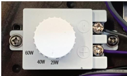
Utilisez le bouton interne de sélection de la puissance pour sélectionner la puissance désirée **(uniquement pour les modèles 60W WCS.)**
