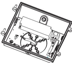
8. Fixez la partie inférieure du boîtier sur le siège de montage avec des vis.
